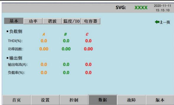
点击“功率”，可以查看电网侧、负载侧、输出侧的视在功率、有功功率、无功功率等数据；
