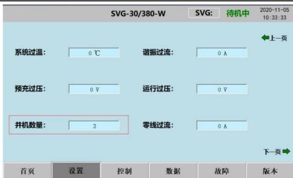
通过点击右上角的 SVG, 会出现 3 个设备可供选择, 即可对所控制的 3 个设备进行设置和控制。3 个设备需要分别设置。
