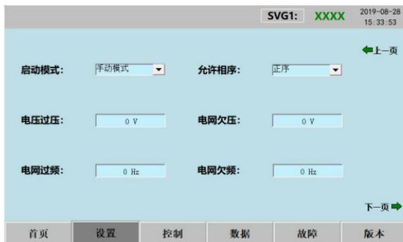
点击“下一页”，可以对系统过温、谐振过流、并机数量、零线过流等参数进行设置；
